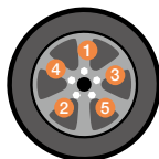
仮止めの順番 (5穴)
