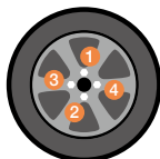
仮止めの順番 (4穴)
